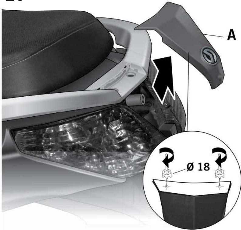
(E) Desmontar la tapeta (A) de la moto, colocar la plantilla según muestra el dibujo y realizar los dos agujeros a un Ø18.
