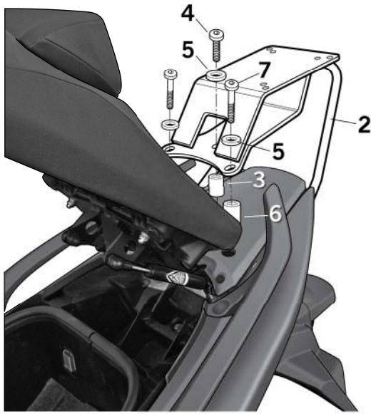
(E) Montar el soporte KIT TOP (2) en zona central superior mediante el distanciador (3), el tornillo (4) y la arandela (5) y en zona superior delantera mediante los distanciadores (6), los tornillos (7) y arandelas (5).
